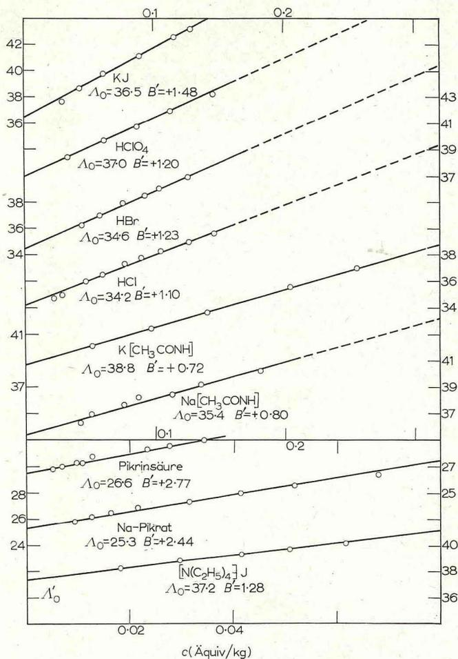
Abb. 1.—Gültigkeit der Shedlovsky-Gleichung (1) für verschiedene Elektrolyte in geschmolzenem Acetamid.
